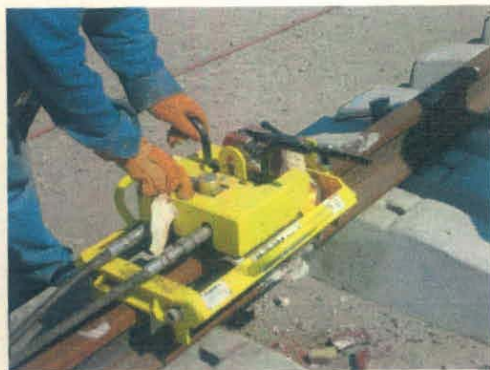
Maquina Hidráulica (Incluye los siguientes accesorios: Apriete de fijaciones, cortar riel, esmerilar, cortamazarota, taladrar, Mod. 2007
